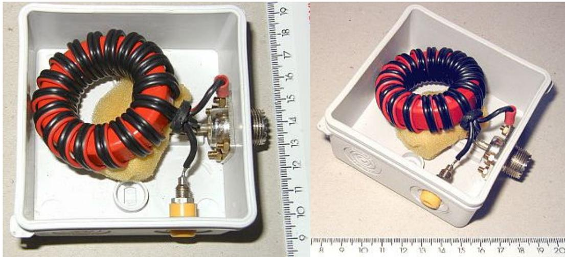
Una scatola come questa in figura si trova presso qualsiasi negozio di elettricità ed è sicuramente del tipo che fa al caso nostro. Si praticano convenientemente i fori per alloggiare il connettore SO-239 e la presa per la long-wire, che si potrà inserire con una comune “banana”. Non è assolutamente necessario che il contenitore sia di metallo, anzi, io non ho mai visto realizzazioni né amatoriali né commerciali fatte con scatolette di metallo.
